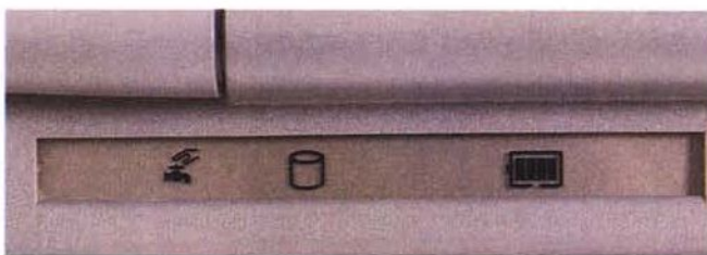
In alto si vede il particolare del controllo di luminosità del display, mentre in basso gli indicatori LCD che forniscono istantaneamente una varietà di informazioni sul sistema.
